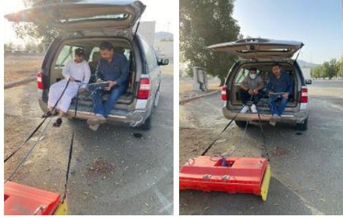
شكل (4): استخدام الهوائي 100 ميغاهيرتز مع جهاز الرادار الأرضي 300SIR ، لإجراء عدد من القطاعات الرادارية بمناطق عرفات ومنى ومزدلفة.
