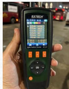
شكل (1): أجهزة محمولة لقياس بعض العوامل البيئية ومعامل جودة الهواء.
