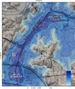
شكل رقم 35: نتائج المحاكاة الهيدروليكية بمنطقة طريق المسجد الحرام بالجبهة الشمالية للحرم المكي الشريف وحدود المنطقة ذات الخطورة.
