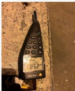
شكل (2): جهاز رصد مستويات شدة الضوضاء موديل (testo 816-1).
